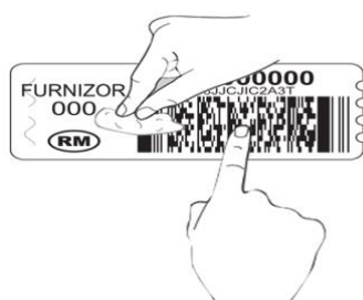
a) aplicarea sigiliului de protecție pe suport
