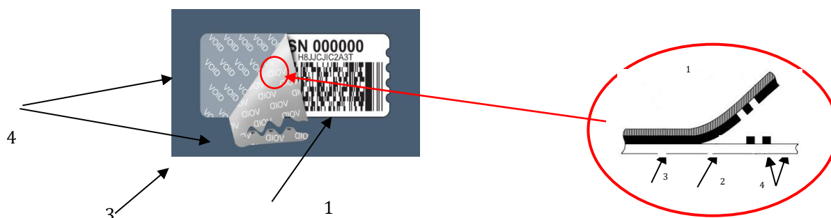
Figura 2. Reprezentarea grafică a elementului de protecție „VOID”
